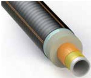
Система гибких труб из сшитого полиэтилена (ПЕКС-а), армированных ниткой из высокомодульного волокна, в полиуретановой теплоизоляции, и соединительные детали к ним. Сертифицированы, имеют гигиеническое заключение.
